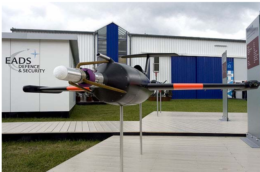
1. ábra. EADS/Dornier DO-DT25 Luneberg lencsével és segédturbinás feketetést sugárzóval felszerelt orrkúpja 31
