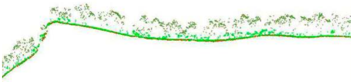
7. ábra: Erdő magasságának meghatározása többszörös visszaverődés detektálásával (Hadley, 2006)
