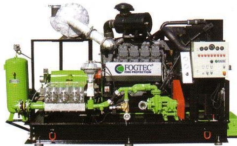
2. sz. ábra: Dízelmotoros szivattyú
