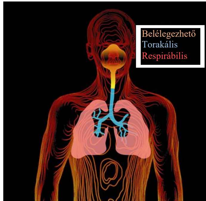
1. ábra Az ISO Standard 7708 és az MSZ EN 481 által definiált aeroszol frakciók szemléltetésére szolgáló modell az emberi légzőrendszerrel [8][9][10]
