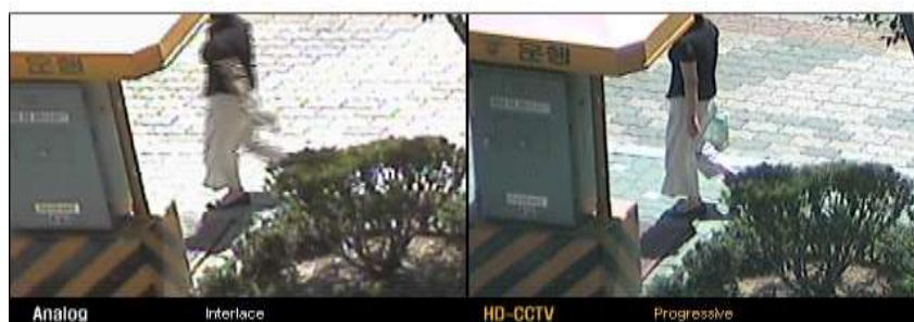
5. kép: Analóg és HD CCTV kép minőségkülönbsége 4
