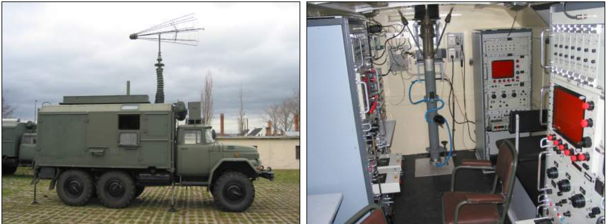
3. kép: Az URH RÁF állomás (légi) telepítve és belső kialakítása. 22
