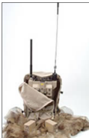
7. kép: Az L3 cég által gyártott szélessávú háton szállítható zavaró berendezés. 46
