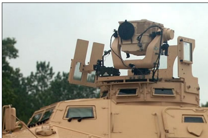
8. kép: Egy lehetséges megoldás, az LRAS3 lézeres target acquisition rendszer. 47
