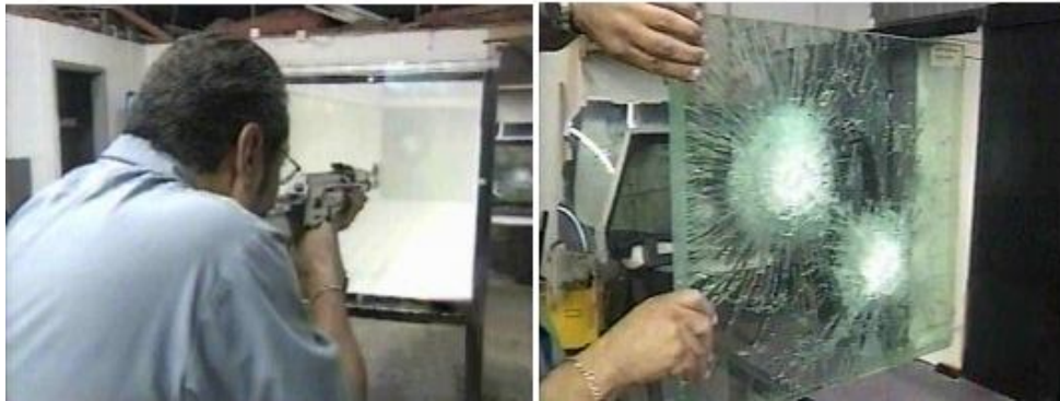
7. ábra. Lövedékálló biztonsági üveg tesztelése
