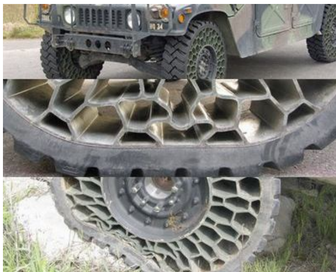
5. ábra. Lövedékálló gumiabroncs (Hooneycomb)
