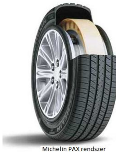
4. ábra. Michelin Pax rendszerű lövedékálló gumiabroncs
