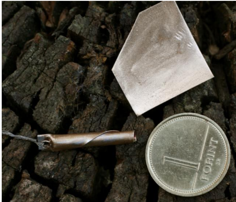
5. ábra. A gyutacs elkészítése akár célszerszámok nélkül is lehetséges volt, így jobban megfelelt a honvédsereg igényeinek, mint a gépigényes lökúpak
