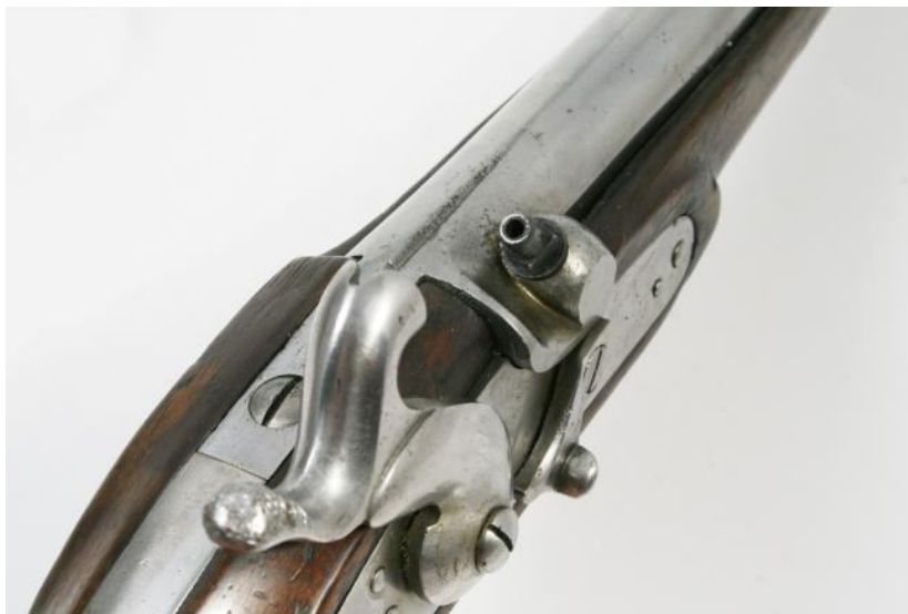
10. ábra. A császári-királyi hadsereg csak későn, 1854-ben tért váltott a lőkupakos lakatrendszerre
