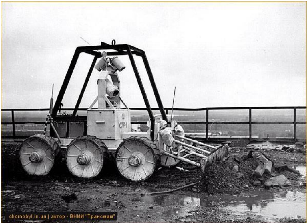
1. kép. Robotjármű a reaktortető tisztításakor [5]
