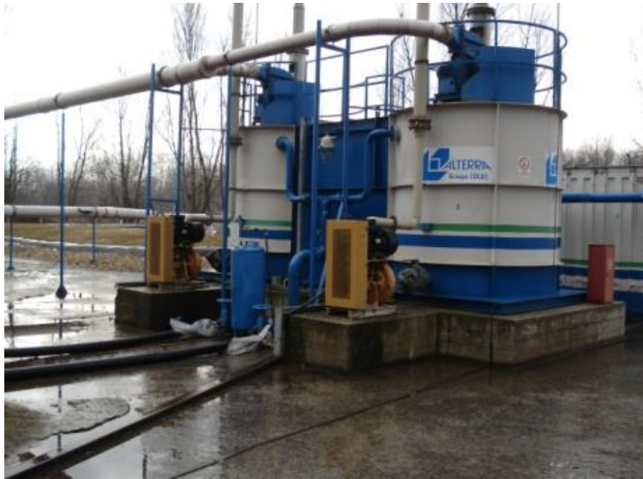
5. ábra. Illó szénhidrogéneket kiválasztó tartály [fotó: Szabó Zsolt]
