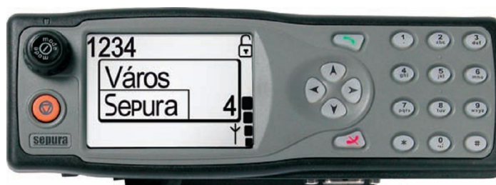
2. ábra. SEPURA SRG 3500 DMO repeater és gateway [6]
