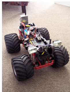
13. ábra. CCE Explorer első verziója előrenéző kamerával és a körbelátó rendszerrel
