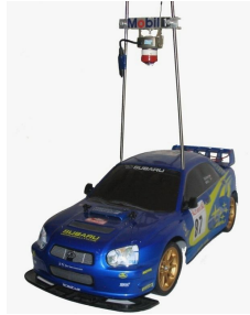
5. ábra. Modellautóból átalakított robot PAL-optikával: PALCOM
