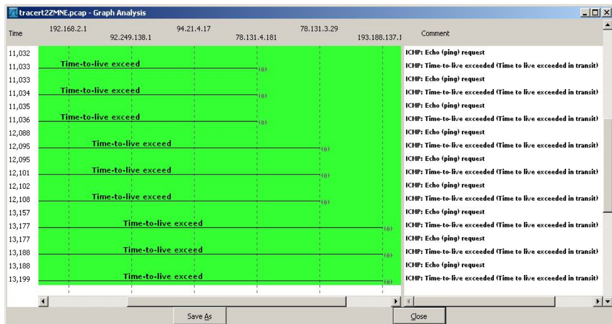
4. ábra – IP útválasztók sorozatát feltérképező traceroute parancs ICMP csomagjainak folyamat diagramm részlete [szerkesztette: Illési Zsolt]
