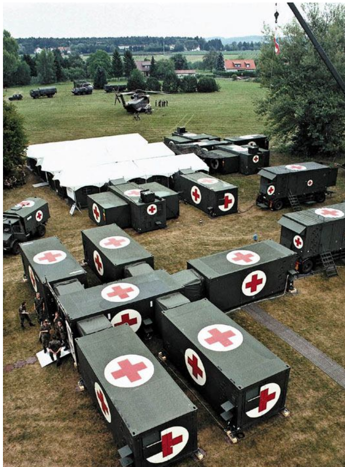
3. kép. ROLE 2 tábori kórház modulrendszerű, konténerizált, sátorponyvás kiegészítéssel [10]. ( www.dgap.org/bfz2/veranstaltung/Praes_260092002_Domann.ppt )
