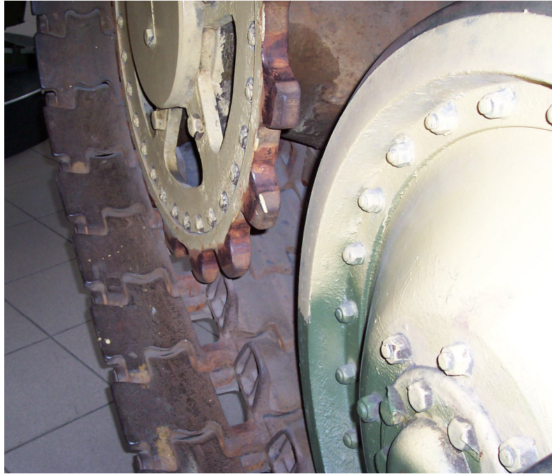
9.ábra. A mellső kihajtású Jagdpanther láncának futófelületén kiképzett tájoló taréjok
