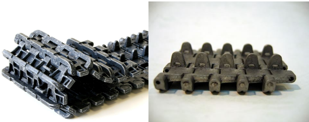
6.-7. ábra. Tiger I bal oldali lánctalp részlete. Jól megfigyelhetőek az elől elhelyezett kapaszkodók, a bordázott, kazettás kialakítású láncfelület, valamint az asszimertikusan elhelyezkedő tájoló taréjok (modellkép)
