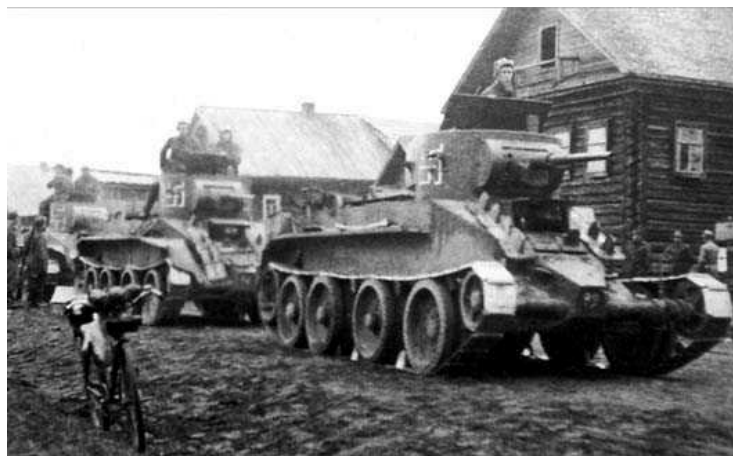
8.ábra. A szovjet BT-5 harckocsin feltűnőek a hosszú lánctagokból álló lánccok
