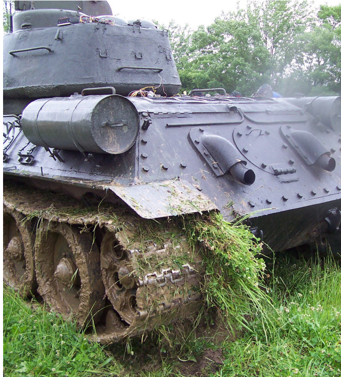
10.ábra. A felázott, füves talajról a lánchajtó kerék és a kocsitest közé beszorult növényzet és sár.
