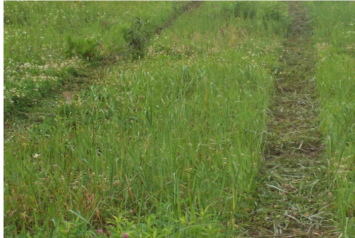
4.ábra. A lánctalp nyoma felázott, füves talajon
