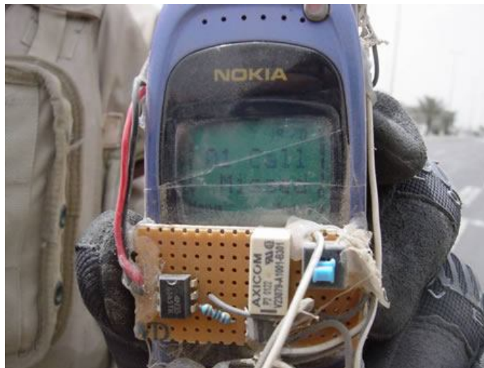
2. kép. Mobiltelefonból épített RCIED vezérlő. A kijelzőjén „1 nem fogadott hívás” felirat olvasható. [K2]
