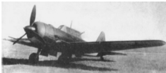
6. ábra. A Szuhoj Su-6-os repülőgép csillagmotorral és soros vízhűtéses motorral készült változatai. Nem jutottak el a sorozatgyártásig.
