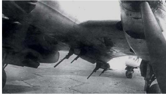
5. ábra. A Tu-2 5 -es repülőgépen törzsbe mereven beépített gépfegyvereket alkalmaztak a gyalogság ellen.
