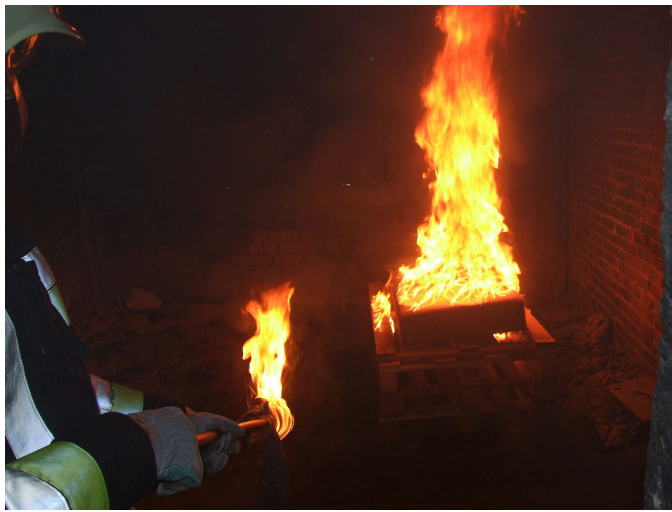
3. kép. Az egységtűz raklapokból, ágybetétből, forgácsból és gázolajból tevődött össze.
