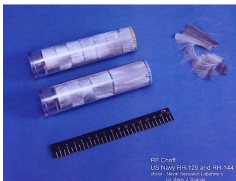
4. ábra RR-129 and RR-144 típusú dipól kapszulák ( http://www.radartutorial.eu/16.eccm/ja09.en.html )
