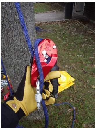
6. ábra Ereszkedőgép előkészítése a befűzött kötéllal és karabinerrel történő együtthasználatra, a felhasználó által a kötéllé irányba tartására. Ilyen ábrák segíthetik a biztonságos eszközhasználat megértését (Fotó: HUNOR Mentőszervezet)
