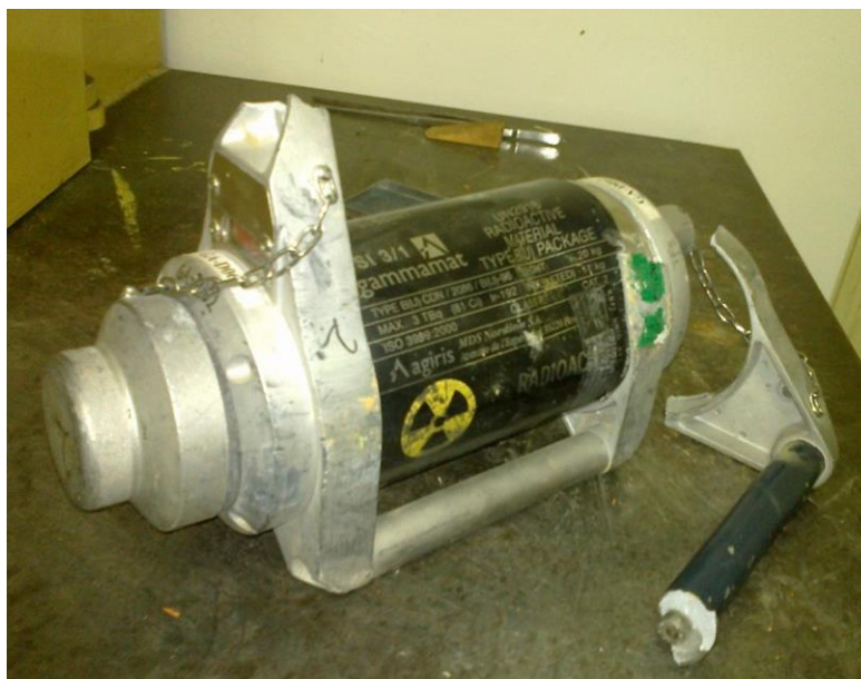
8. ábra A balesetben sérült Gammamat munkatartó [15]
