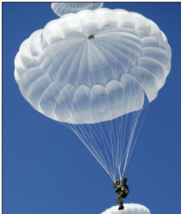
9. kép. Az alakos szabású ejtőernyőkupola a D-10 típusú fő ejtőernyő jellegzetessége. [20]
