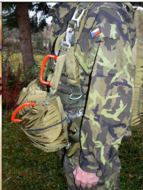
13. kép. Hagyományos elrendezés: hátul az OVP-80.08 típusú fő ejtőernyő, elől a ZVP-80.08 típusú tartalék ejtőernyő. [29]
