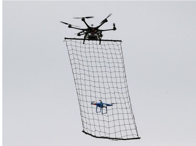
1. ábra A hálókilövő drónelhárító drón [11]
