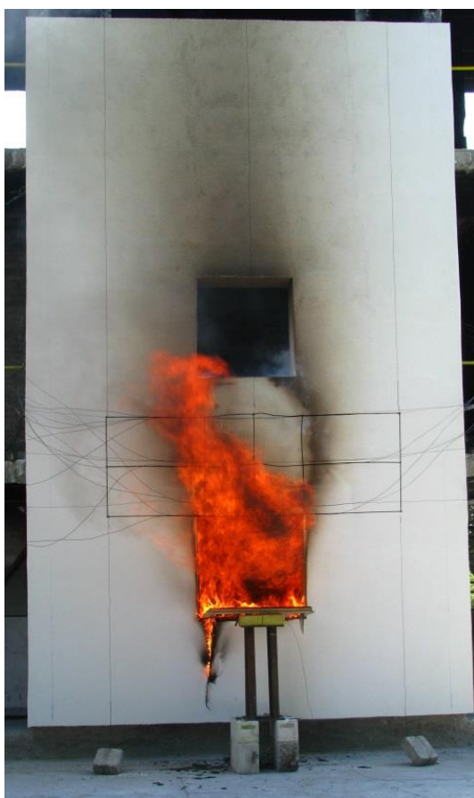
1. kép Homlokzati hőszigetelő rendszer MSZ 14800-6:2009 szerinti vizsgálata. (Forrás: ÉMI Nonprofit Kft. Tűzvédelmi Vizsgáló Egység)
