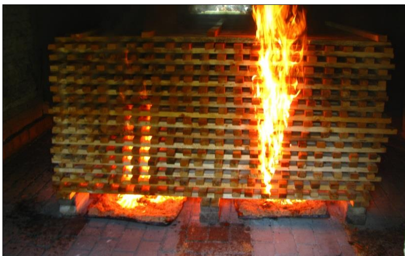
2. kép A 650 kg fenyőfa lécz tüzelőanyag közvetlenül gyújtás után. ( Forrás: ÉMI Nonprofit Kft. Tűzvédelmi Vizsgáló Egység)
