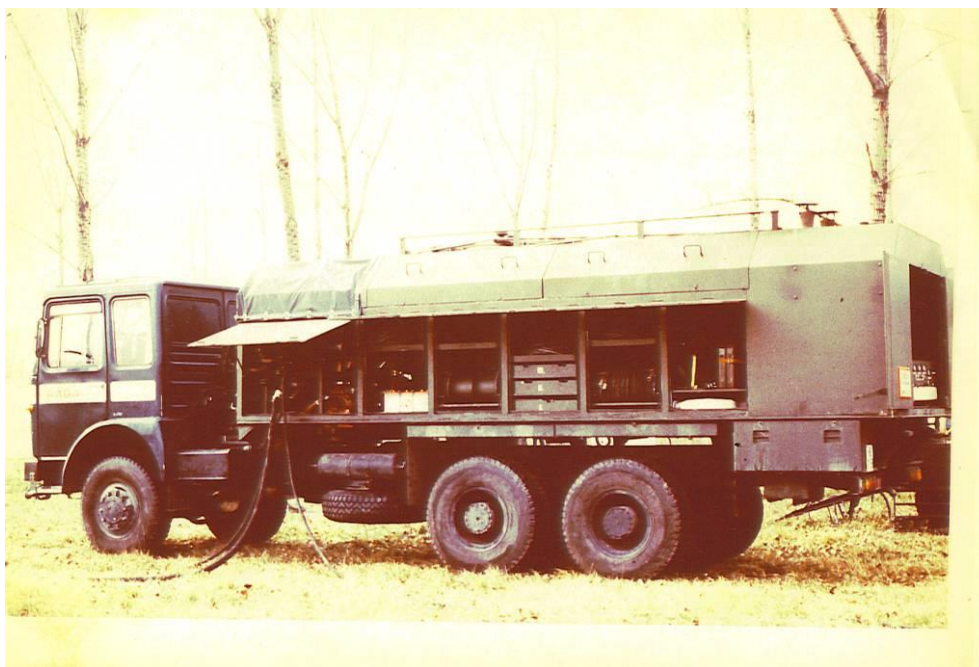
10. ábra: FMG-90 mentesítő gépkocsi (A szerző archívumából)
