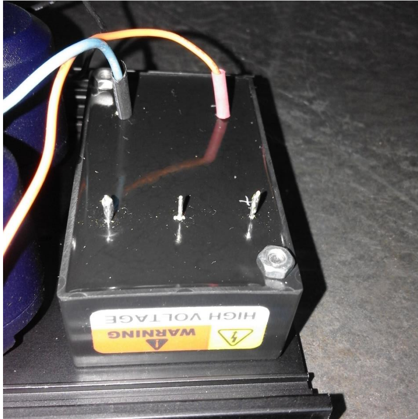
1. kép. A detektorba épített nagyfeszültségű DC/DC konverter (Szerző saját felvétele)
