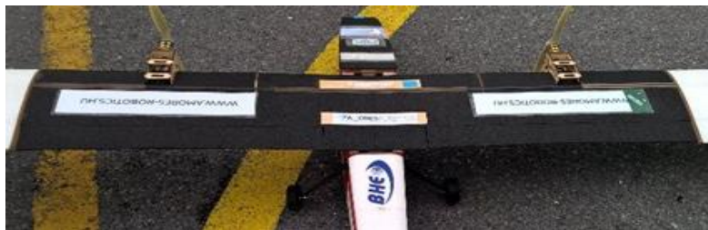
6. ábra. A motorgondolák elhelyezése 7
