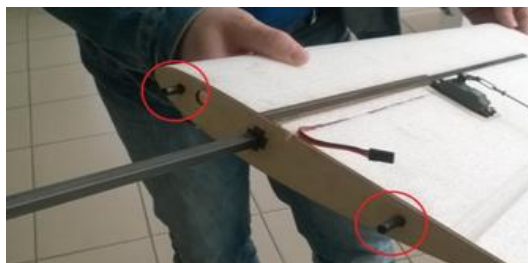
10. ábra. A szárnyvégek kapcsolódása a szárnyközéphez 11
