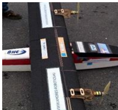
14. ábra. A motorgondolák elhelyezkedése a szárnyközépen 15
