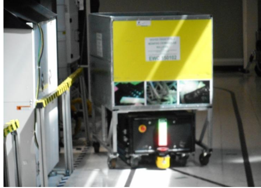
18. ábra: hulladékszállító robot munkában
