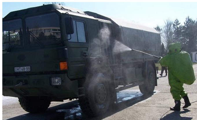
1. kép. Mentésítés/fertőtlenítés UNIJET FOG vízköddel oltó berendezéssel (forrás: Saját felvétel)
