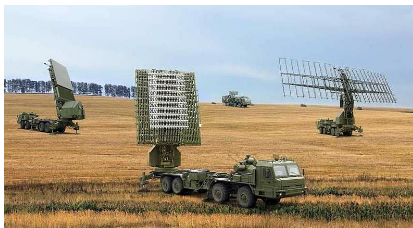
4. ábra. Heo-M (55Ж6МЕ) többfunkciós felderítő radar 5 [14]
