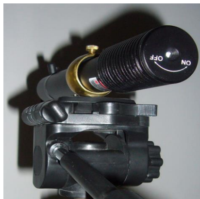
6. kép. Az 589 nm-es 50 mW-os lézerberendezés földi szimulációs kísérlet elvégzésére
