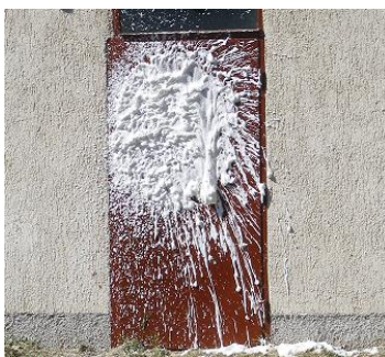
1. sz. kép Tűzoltóhab a függőleges felületen
