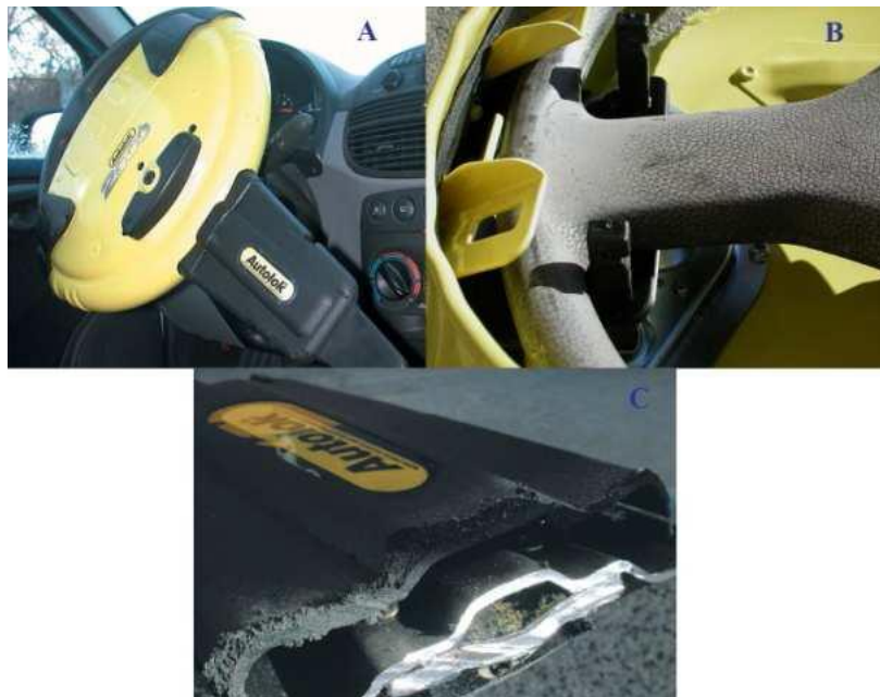
5. ábra. Az AUTOLOK 2000 kormányzár A) A kormányzár felhelyezve; B) A kormánykulló és a tuskék kapcsolata C) A rúd belső keresztmetszete [7]
