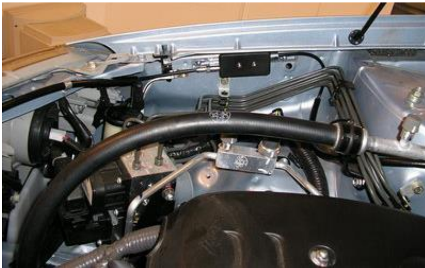
7. ábra. A Bear-Lock mechanikus motortérzár beépítve [9]
