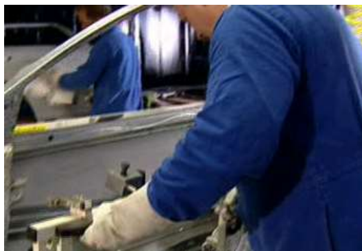
16. ábra. A kész széria karosszéria átkerül a „különleges” gyártósorra, karosszéria elemeinek megerősítése az első folyamat [16]
