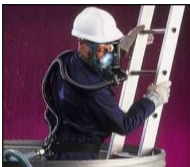
8. ábra. Frisslevegős passzív légzésvédő eszköz forrás: http://www.kovox.hu/html/legzeskulsolevegos.html (2013. 05. 05.)
